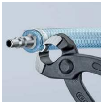
Utěsnění pneumatické hadice na rychlospojce
