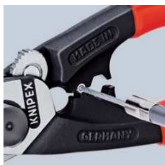
Nalisování koncové dutinky na tažné lano
