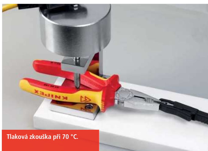
Zkouška přilnavosti izolovaných rukojetí s 500 N.
