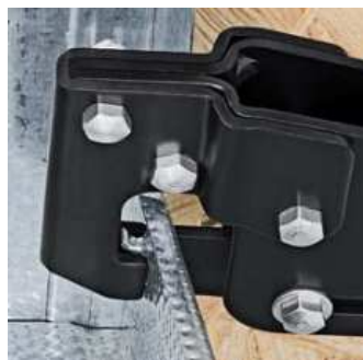
Nasazení kleští na dva spojované profilované plechy
