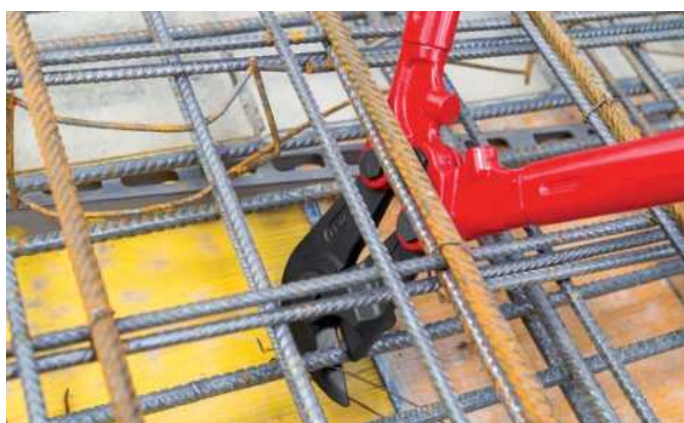
Zvláštní tvar hlavy pákových kleští na pletivo 71 82 950 umožňuje řezání ploché konstrukční oceli
