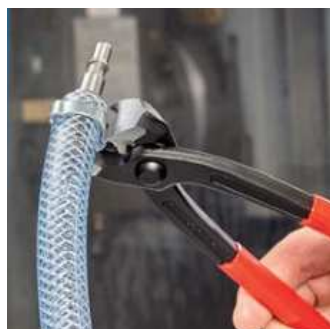
Utěsnění pneumatické hadice na rychlospojce pomocí čelních čelistí
