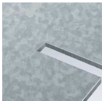
Prostřížení a odlomení třísek v jedné pracovní operaci
