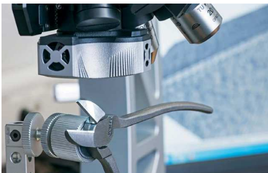
U bočních štípacích kleští se přesně proměřuje tvar a drsnost břitů optickým 3D měřicím systémem.
