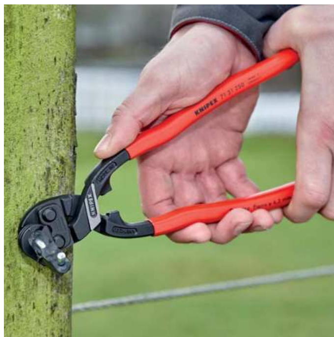
Dvouruční ovládání pro maximální řeznou sílu
