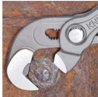
Práce se zrezivělou maticí se zaoblenými hranami
