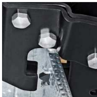
Lisovací nástroj je stlačován profilovanými plechy
