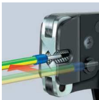
97 53 08: lisování kabelových koncovek paralelně ze strany do průřezu 2,5 mm 2 např. ve stísněných pracovních podmínkách
