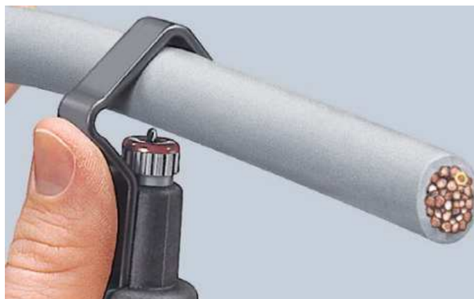
Nastavení nástroje pro obvodový řez
