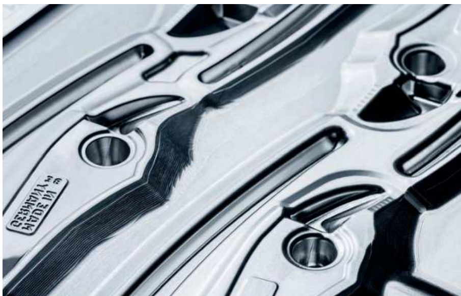
Kovací zápustka pro silové boční štípací kleště s kovaným kloubem.
