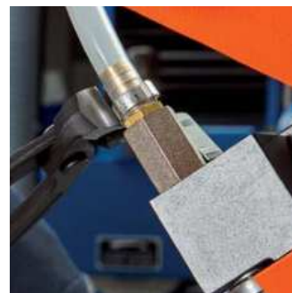
Utěsnění připojení hadice na centrálním mazání
