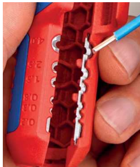
Odizolování jednotlivých vodičů
