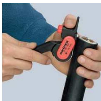
Nasazení nářadí pro odstrižení v podélném směru
