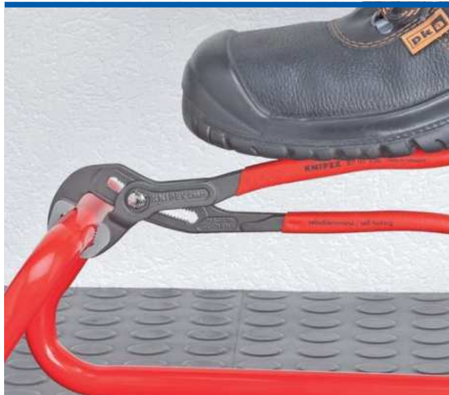
Žuby přesazené proti směru otáčení způsobují samosvorný efekt a zabraňují sklouznutí po obrobku.
