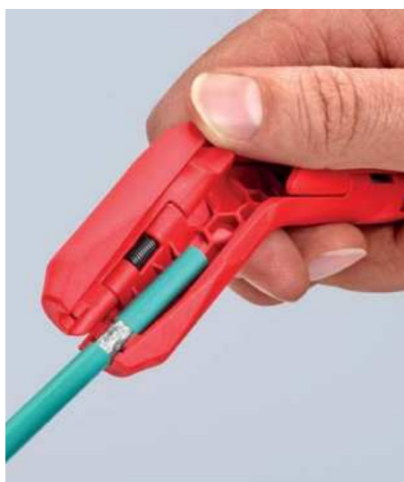
Odizolování datového kabelu
