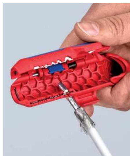
Odizolování koaxiálního kabelu
