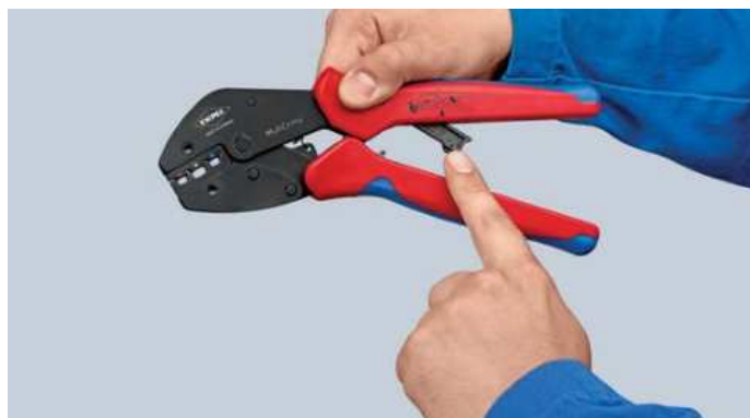
Sklapte servisní páku a promáčkněte kleště – jsou připraveny pro příští použití
